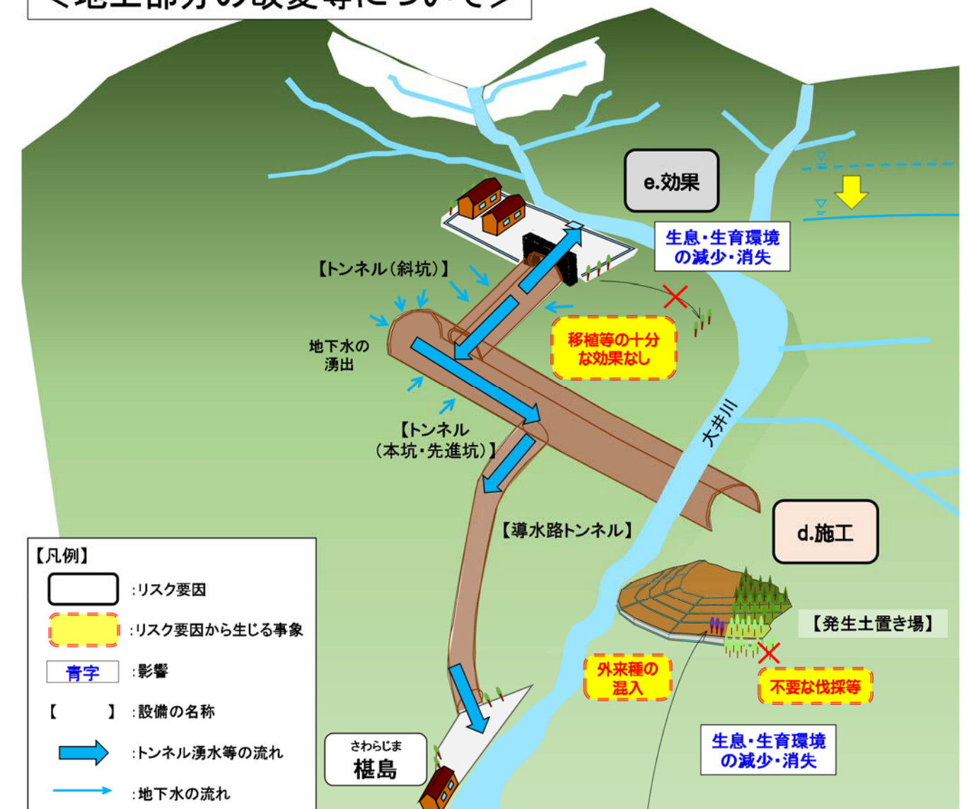
図 7.6 地上部分の改変等についてのリスク要因、事象、影響の関係性（位置イメージ図）
