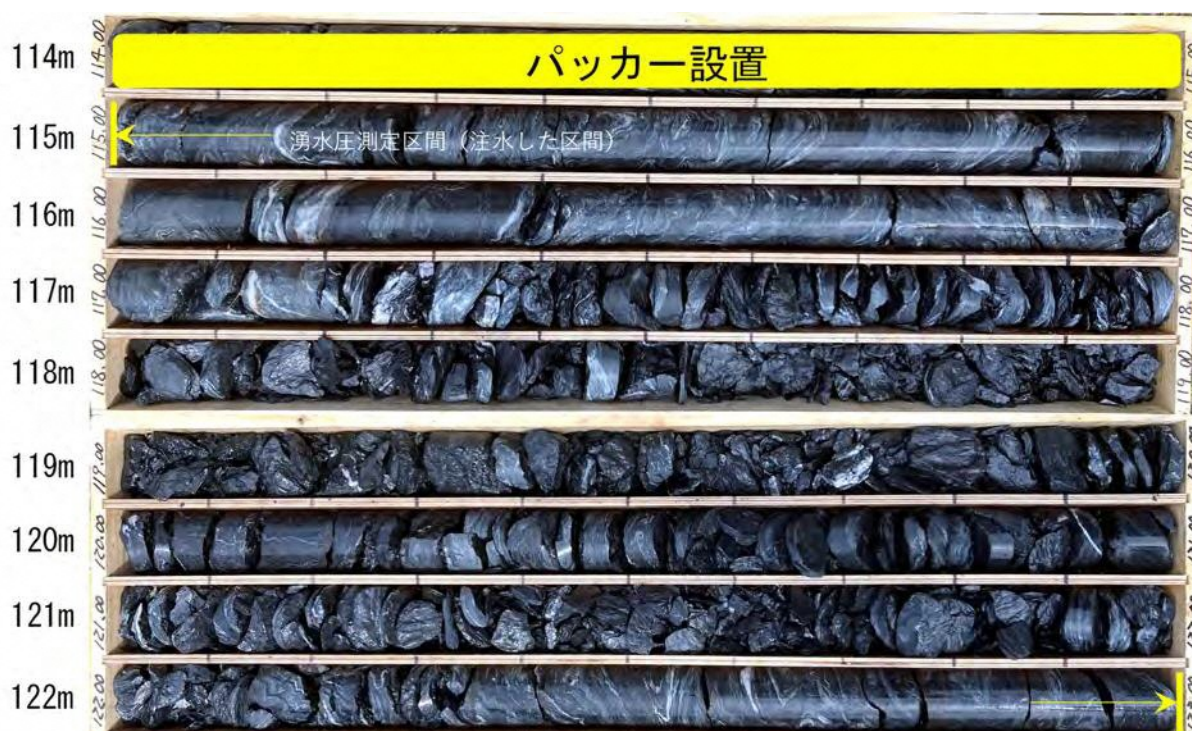
写真 5 孔内湧水圧測定 No. 3 (115.0m~123.0m) コア写真
