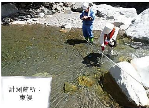
図38.河川流量の計測状況 (東俣)
