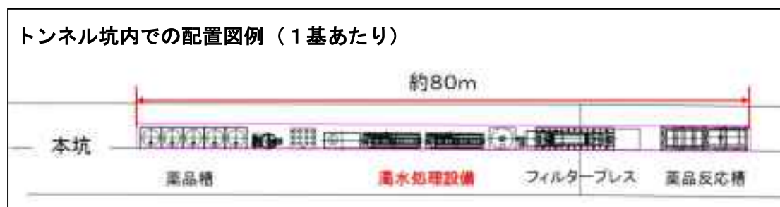
図 4.57 濁水処理設備の配置計画（仮に 3 \text{ m}^3/\text{秒} の濁水が発生した場合）
