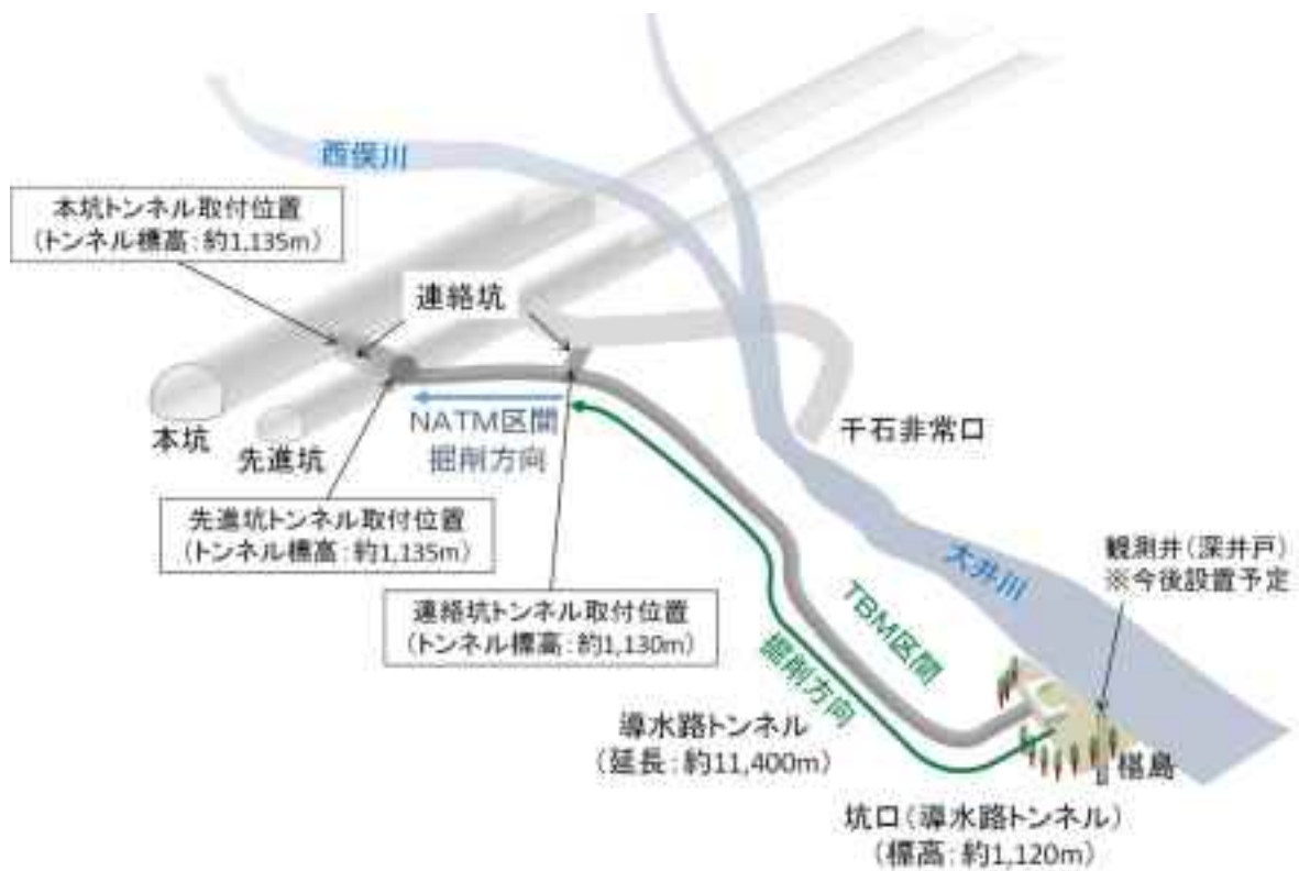
図 2.5 導水路トンネル 概念図
