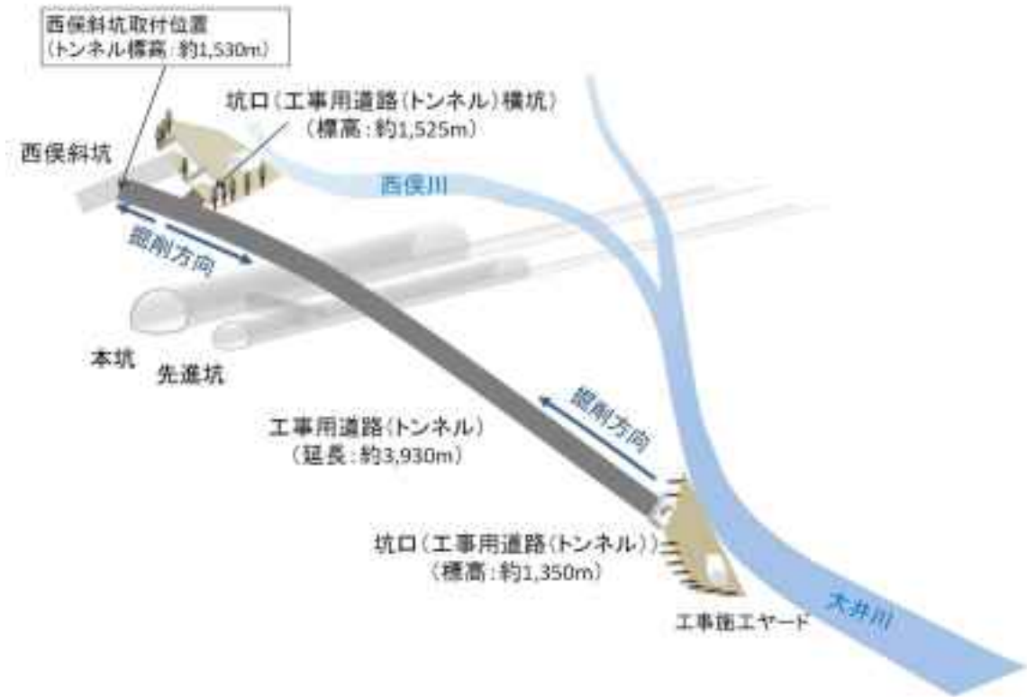
図 2.6 工事用道路 (トンネル) 概念図
