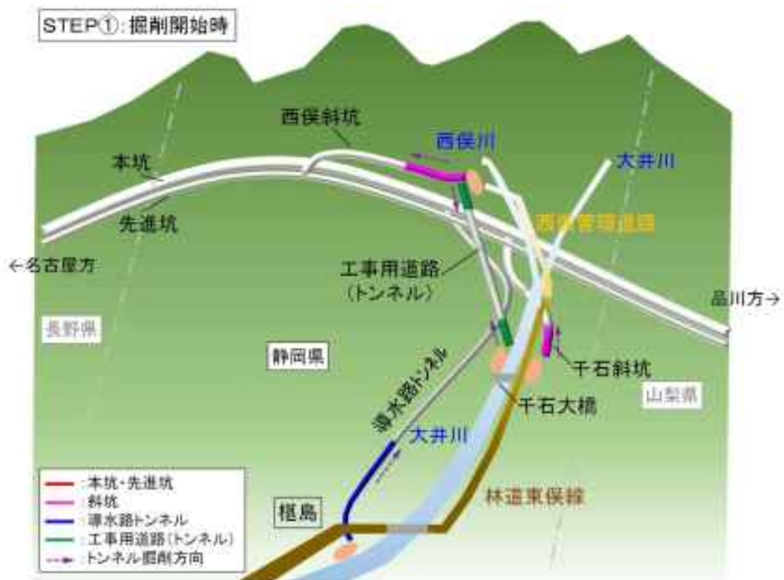
図 2.9 トンネル工事の進捗図 (STEP①)
