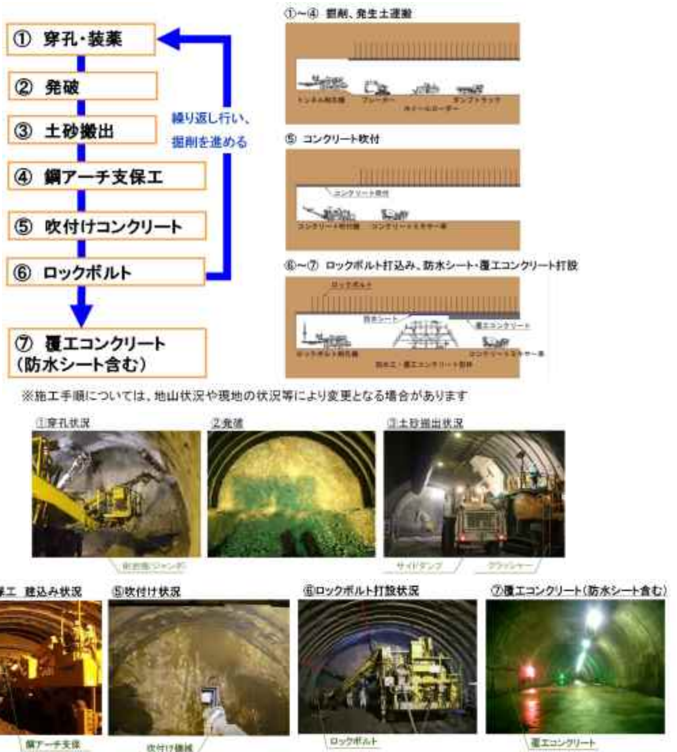
図 2.8 NATMの標準的な施工手順
