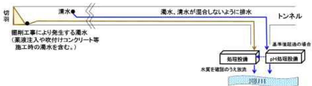
図 4.56 トンネル湧水の清濁分離 (イメージ)
